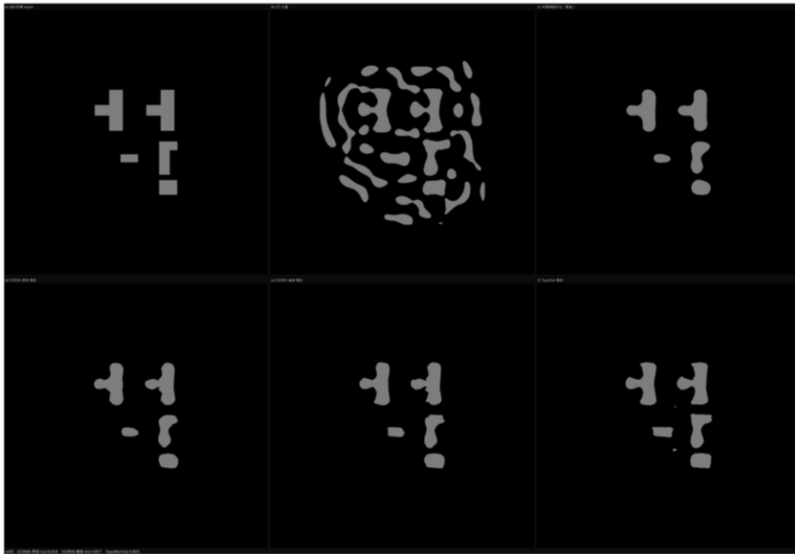
(c) 形態學壓力範例：上排為擾動光罩，下排為重新計算的物理印出結果。
